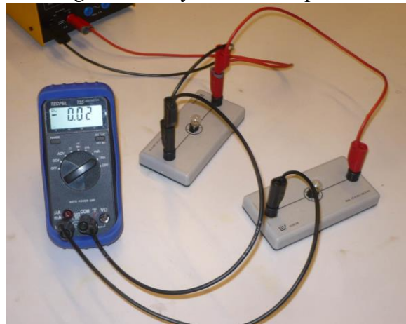
Måling af strømstyrke imellem pærene
