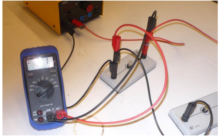
Måling af spænding over pære 1
